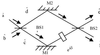
Fig. 1. Mach-Zehnder interferometer.
